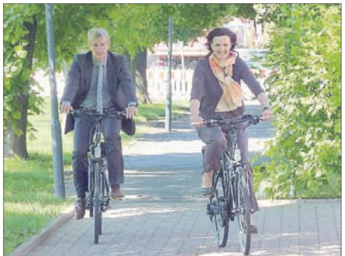
Therme Betriebsleiter Dieter Blumentritt gab noch einige technische Details bekannt. Der Akku hat ein Gewicht von rund 2,5 kg, das gesamte Rade ist für 120 kg Gesamtmasse zugelassen. Im ebenen Gelände reicht die elektrische Unterstützung für gut 50 bis 60 Kilometer. Wird man schneller als 35 km/h schaltet sich der elektrische Antrieb ab und man ist dann allein auf seine Beinkraft angewiesen.
